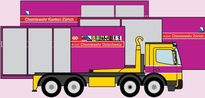
**Container Flüssiggas, Flüssigkeiten, Gaswäscher, inkl. Wechsellader**
